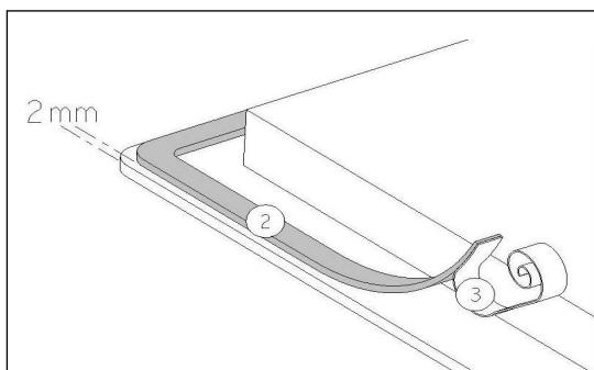
Die Dichtung (2) nach Abnehmen der Schutzfolie (3) mit 2 mm Abstand der Ausserkannte des Glases aufkleben.
